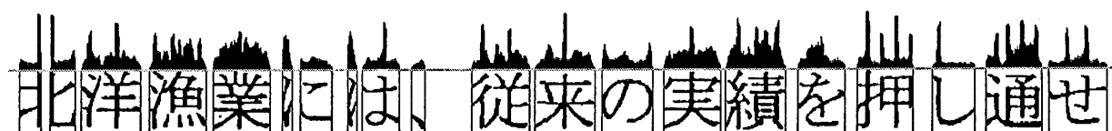
図 2.1: 射影 (投影) 分布を用いた文字切り出しの例
